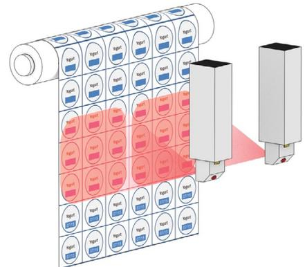
Un seul laser 3350 ou 3640 peut prendre en charge une application à grande laize qui nécessitait auparavant deux lasers.
