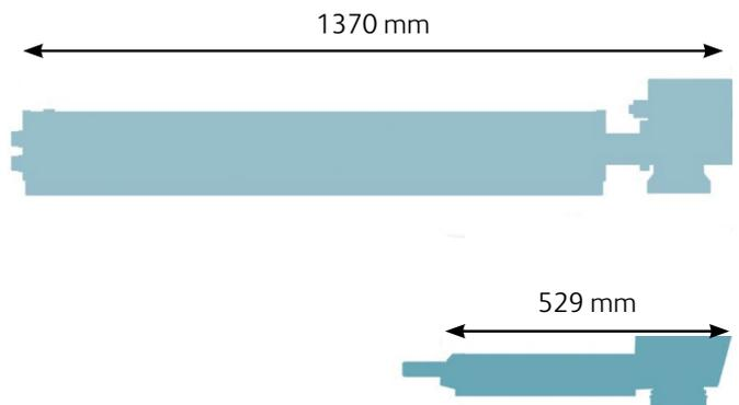
Comparaison de la taille basée sur un laser fibré Videojet 7610 et un laser Nd:YAG de 100 watts
